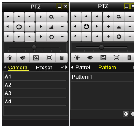
Figura 4.14 Finestra di Controllo PTZ
